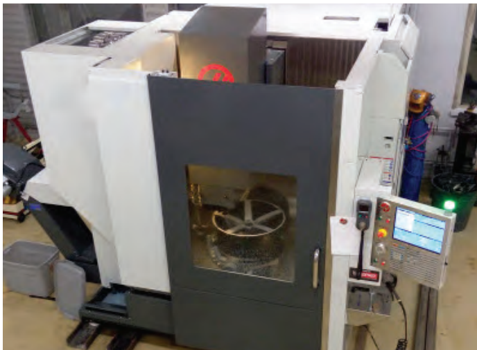
Usinage en 5 axes d'une roue sur centre d'usinage Haas à partir d'un programme ESPRIT.
